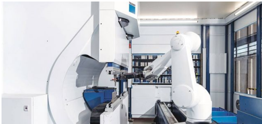
Yenilikçi yüksek hızlı büküm hücresi: TruBend Cell 7000, küçük parçaların özellikle dinamik ve ekonomik şekilde bükülebildiği kompakt bir sistem.
