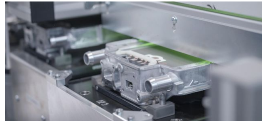
<p>Lazer 2: Yeşil lazer ile bakır kontaklaması. TRUMPF lazerlerinin yeşil dalga boyu, bakırda daha yüksek emilim derecesine sahip nitelikte. Doğru
