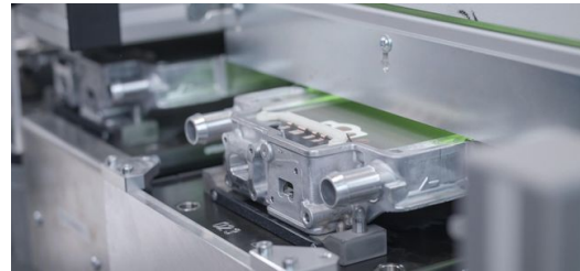
Lazer 2: Yeşil lazer ile bakır kontaklaması. TRUMPF lazerlerinin yeşil dalga boyu, bakırda daha yüksek emilim derecesine sahip nitelikte. Doğru pals
