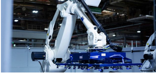
İki boşaltma robotunun işleri başından aşkın: Komponentler lazer kesim odasından seri bir şekilde çıkıyor.
