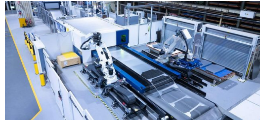
TruLaser 8000 Coil Edition'in genel görünümü: Bu görsel, Fendt'in sac yerine rulodan kesim yaptığı geride ne kadar az miktarda sac fazlalığı kaldığını gösteriyor.
