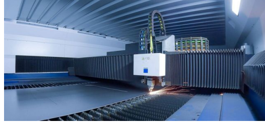
Lazer kafası adeta sonsuz gibi görünen sac şeridin üzerinde gezinerek Fendt traktörlerinin dış kaplama parçalarının konturlarını kesiyor.
