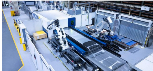
TruLaser 8000 Coil Edition'in genel görünümü: Bu görsel, Fendt'in sac yerine rulodan kesim yaptığında geride ne kadar az miktarda sac fazlalığı kaldığını gösteriyor.
