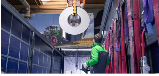
Bir vinç kalkışı artık beş forklift sürüşünün yerini alıyor: Verimlilikte devasa bir kazanç.
