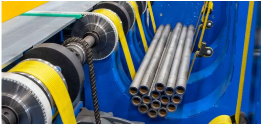
Borular, TruLaser Tube 7000'de ölçüye göre kesildikten sonra sistem ağına taşıyor ve burada da robot tarafından bir demet kanalına yerleştirilerek bir tezgah üzerinde ayrıştırılıyor.
