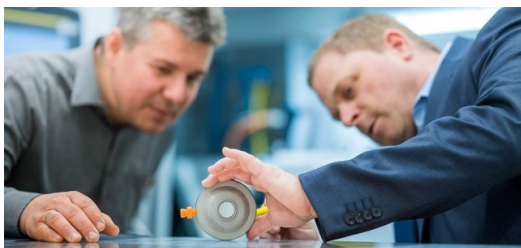
Matthias Luik (till höger) med en additivt tillverkad kylvätskedysa, chef för forskning och utveckling hos Horn, anser att additiv tillverkning är avgörande för ledande teknologi.
