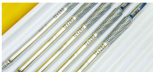
Med TruMicro Mark ultrakorta pulslasrar från TRUMPF applicerar företaget robusta och långvariga markeringar.
