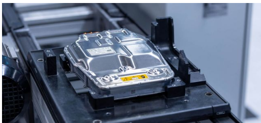
Laser 1: Svetsa aluminium gastätt. Webasto använder en skivlaser som fungerar även under atmosfärstryck utan skyddsgas - så snabbt som möjligt, så effektivt som möjligt och med en porfri svetsfog.
