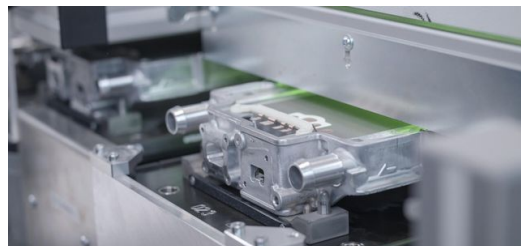
Laser 2: Kontakta koppar med grön laser. Den gröna våglängden hos TRUMPF-lasarna har en högre grad av absorption i koppar. Med rätt pulsekvens kan svetsdjup uppnås med extrem repeter noggrannhet - sprutfritt och utan någon skyddsgas.
