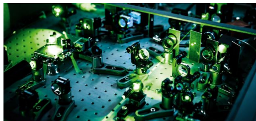
Forskargruppen i Lund, Sverige, använder femtosekundlaserpulser för att generera så kallade höga övertoner. De använder dessa för att generera attosekundlaserpulser och använda dem för att observera atomära processer.
