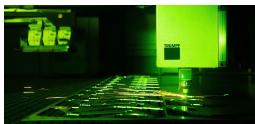
Processsäkerhet är för Hans Sanders a och o. Av detta skäl är han särskilt entusiastisk över säkerhetskonceptet på TruLaser Center 7030. SmartGate som är integrerat i borstbordet förhindrar t.ex. att detaljerna välter under skärningsförloppet.
