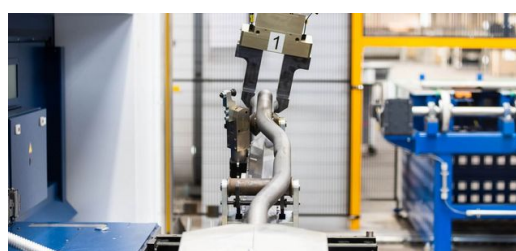
Anläggningarna i maskinnätverket drivs automatiskt av ett robotsystem som automatiskt transporterar delarna från ett bearbetningssteg till nästa.
