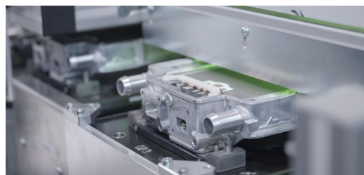
<p>Laser 2: Spájanie medi zeleným laserom. Zelená vlnová dĺžka laserov TRUMPF má väčšiu mieru absorpcie v medi. Pri správnej sekvencii pulzov je
