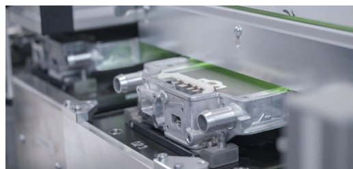
Laser 2: Spájanie medi zeleným laserom. Zelená vlnová dĺžka laserov TRUMPF má väčšiu mieru absorpcie v medi. Pri správnej sekvencii pulzov je
