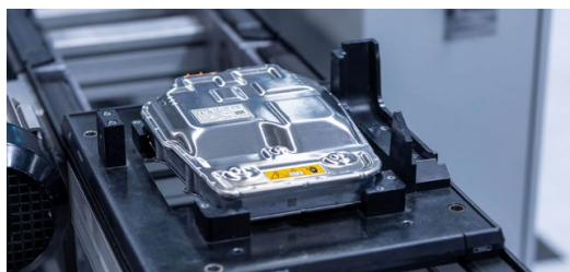
<p>Laser 1: Plynotesné zvráranie hliníka. Webasto používa diskový laser, ktorý pracuje aj pri atmosférickom tlaku bez ochrannej atmosféry – čo
