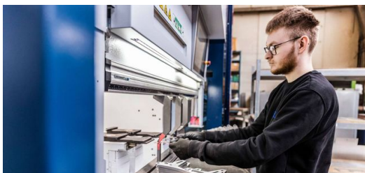
Компания «Трумпф» представила на выставке в Дрездене новую модель лазерной гибочной машины TRUMPF. TruBend 7020 2020 имеет увеличенную длину рабочего стола и возможность работы с листами толщиной до 10 мм.
