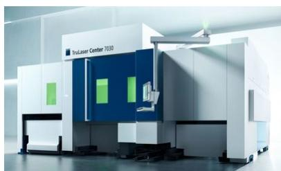
Лазерный станок TruLaser Center 7030 – это интегрированное производственное оборудование для обработки металлов. Оно включает в себя лазерную установку, рабочую зону и систему подачи материалов. Станок может выполнять различные операции, такие как резка, сварка и гравировка. Благодаря высокой точности и производительности, TruLaser Center 7030 является идеальным решением для различных отраслей промышленности.
