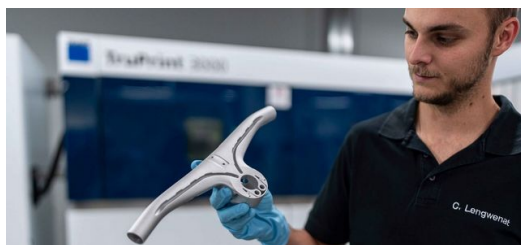
Ghidonul se bazează în esență pe o unitate cu conducte semi-interne pentru cablurile de frână.
