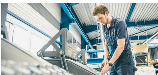
<p>A TruMatic 7000 corta e molda as chapas estriadas de alumínio para os equipamentos EGYM sem arranhões e com a melhor qualidade.</p>
