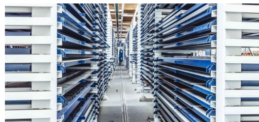
Para Tim Ungerer, o armazém STOPA totalmente automatizado com 400 locais de armazenamento é um dos destaques das extensas medidas de automação.
