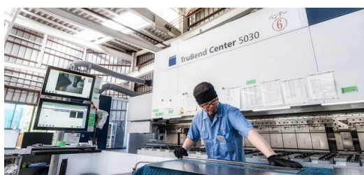
<p>Um funcionário trabalha na <a href="https://www.trumpf.com/de_DE/produkte/maschinen-systeme/biege-maschinen/trubend-center-serie-5000/">TruBend Center 5030</a>: assim é fabricada a cadeira "Orisu".</p>
