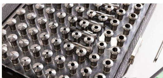
Graças às ferramentas altamente flexíveis, o ajuste do suporte de peças e o alinhamento dos sistemas ópticos dura menos que cinco minutos; aqui as ferramentas para suporte de peças.
