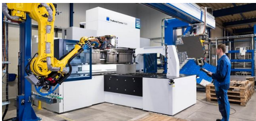
Somente a nova máquina de dobra oscilante, TruBend Center 7020, tornou possível a produção do fogão de campo. Com este sistema a equipe da Kuipers conseguiu dobrar automaticamente a câmara de combustão relativamente grande de 333 milímetros.
