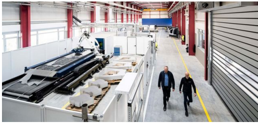
O sistema de blanking a laser de 34 metros de comprimento da TRUMPF economiza material em bruto e cerca de 4000 toneladas de CO2 por ano.
