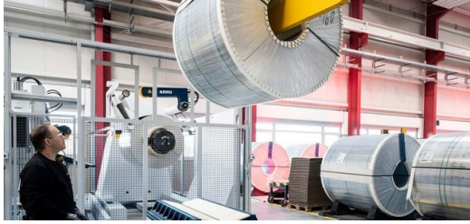
O operador da máquina Martin Müller iça uma bobina de alumínio de 16 toneladas na zona de carregamento da TruLaser 8000 Coil Edition da TRUMPF.
