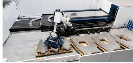
Blanking a laser: um robô organiza automaticamente os componentes cortados.
