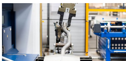
Os sistemas na rede de máquinas são operados automaticamente por um sistema robotizado que transporta automaticamente as peças de uma etapa de processamento para a próxima.
