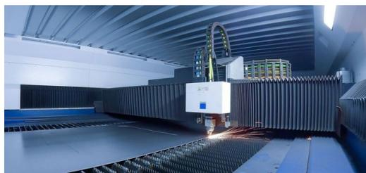
O cabeçote do laser passa zunindo sobre a aparentemente interminável tira de chapa metálica e corta os contornos das partes externas dos tratores Fendt.
