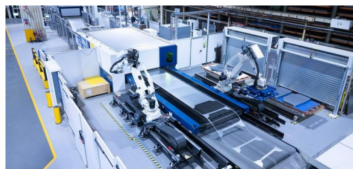
A TruLaser 8000 Coil Edition em visão geral: Esta imagem mostra quanto menos desperdício de chapa metálica resta quando a Fendt corta a partir
