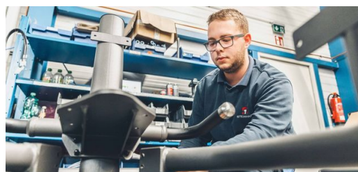
A articulação de um equipamento fitness EGYM consiste principalmente em tubos de aço ovais. Após o processamento em uma máquina de corte de tubos a laser da TRUMPF, o equipamento recebe um acabamento sofisticado em cinza escuro através de revestimento em pó.
