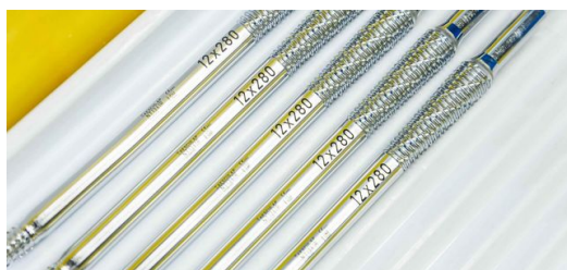
Com os lasers de pulso ultracurto TruMicro Mark da TRUMPF, a empresa aplica marcações robustas e duradouras.
