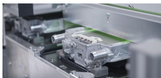
Laser 2: Fazer o contato de cobre com o laser verde. O comprimento de
