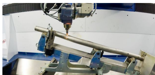
Com o sistema a laser 3D TruLaser Cell 8030 da TRUMPF, é possível recortar contornos precisos que não podem ser criados antes da dobra, caso contrário seriam deformados.
