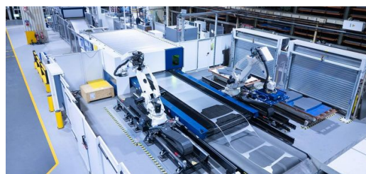
Pięny widok TruLaser 8000 Coil Edition: to zdjęcie pokazuje, o ile mniej odpadów blachy pozostaje, gdy firma Fendt tnije ze zwoju zamiast z arkusza blachy.
