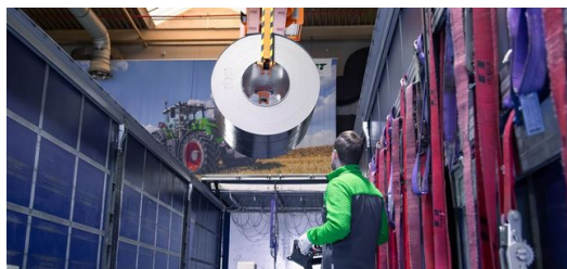
Jedno podniesienie dźwigu zastępuje teraz pięć przejazdów wózka widłowego – to ogromny wzrost produktywności.
