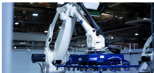
Dwa roboty rozdawcze mają przed sobą nie lada zadanie: elementy wychodzą z komory cięcia laserowego strumieniami.
