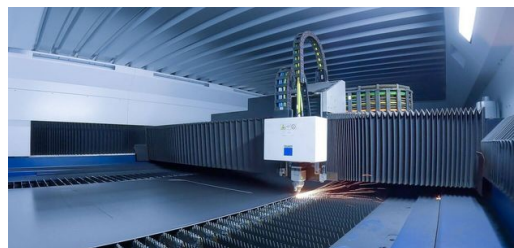
Głowica lasera wiruje nad pozornie niekończącym się pasem blachy i wycina kontury zewnętrznych części poszycia traktorów marki Fendt.
