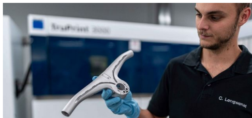
Kierownica opiera się w dużej mierze na jednostce z półwewnętrznymi kanałami na kable hamulca.
