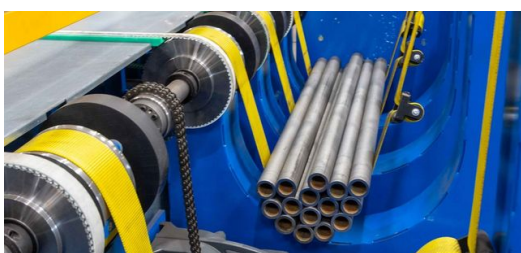
Po przycięciu rur na wymiar na maszynie TruLaser Tube 7000, są one transportowane do zespołu urządzeń, gdzie robot umieszcza je w zasobniku na wiązki, a następnie rozdziela je na stole.
