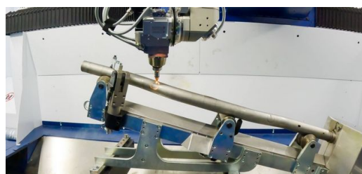
System laserowy 3D TruLaser Cell 8030 firmy TRUMPF może być używany do wycinania precyzyjnych konturów, których nie można wprowadzić przed gięciem, ponieważ w przeciwnym razie uległyby deformacji.
