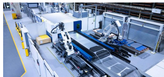
De TruLaser 8000 Coil Edition in totaalzicht: deze foto laat zien hoeveel minder plaatafval er overblijft als Fendt uit de coil snijdt in plaats van uit de
