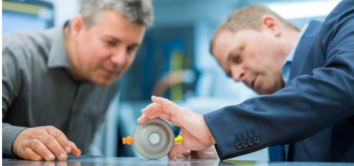
Houd de aanpak met additive manufacturing voor technologische leiderschap voor onontbeerlijk: Matthias Luik (rechts), directeur onderzoek en ontwikkeling bij Horn, met een via additive manufacturing geproduceerde koelmiddelsproeier.
