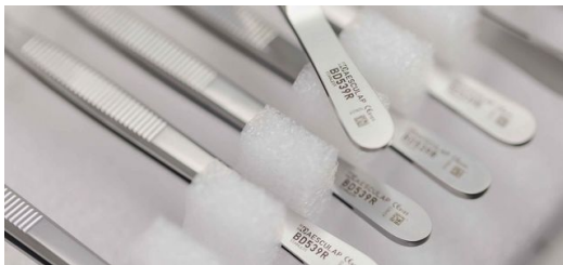
Het team in Suzhou zorgt elk jaar voor nauwkeurige markeringen op meer dan een miljoen chirurgische instrumenten, sommige in kleine series.
