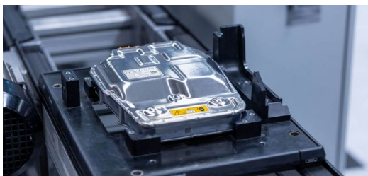
Laser 1: aluminium gasdicht lassen. Webasto gebruikt een schijflaser, die ook onder atmosferische druk zonder schermgas werkt - zo snel mogelijk, krachtig en met een porievrije lasnaad.
