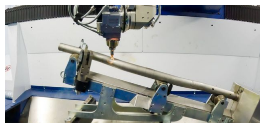
Met de 3D-laserinstallatie TruLaser Cell 8030 van TRUMPF kunnen nauwkeurige contouren worden uitgesneden, die vóór het buigen niet kunnen worden gemaakt, omdat ze zouden vervormen.
