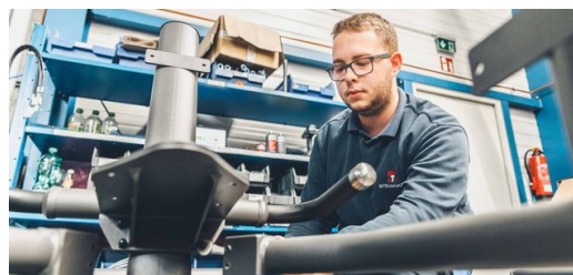
L'asta di un'attrezzatura per il fitness EGYM è composta in prevalenza da tubi ovali in acciaio. Dopo la lavorazione su una macchina taglio laser di tubi TRUMPF, riceve una pregiata finitura grigio scuro tramite rivestimento con polveri.
