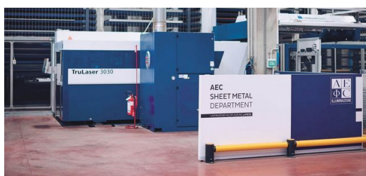
Con la macchina taglio laser 2D TruLaser 3030 fiber, AEC Illuminazione ha gettato le basi per uno stretto rapporto di collaborazione con TRUMPF. Il collegamento di un magazzino automatizzato ha notevolmente accelerato la produzione.
