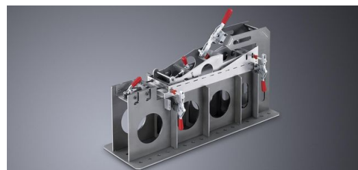
Weil beim Laserschweißen der „Null-Spalt“ das Maß der Dinge ist, braucht es praktisches Wissen um die passende Spannvorrichtung.
