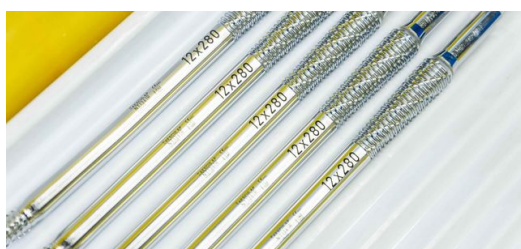
Con i laser a impulsi ultracorti TruMicro Mark di TRUMPF l'azienda realizza marcature resistenti e durevoli.
