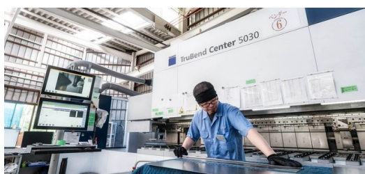
Un dipendente lavora sulla TruBend Center 5030 : ecco come viene prodotta la sedia "Orisu".
