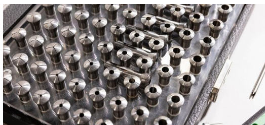
Grazie a strumenti altamente flessibili, l'allestimento del portapezzi e l'allineamento del sistema ottico richiedono meno di cinque minuti: ecco gli utensili per i portapezzi.
