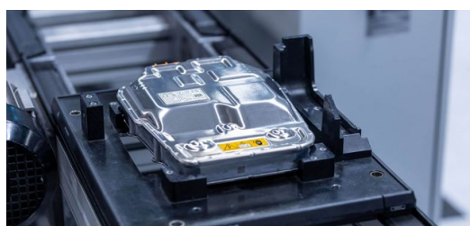
Laser 1: saldatura di alluminio a tenuta di gas. Webasto utilizza un laser a
