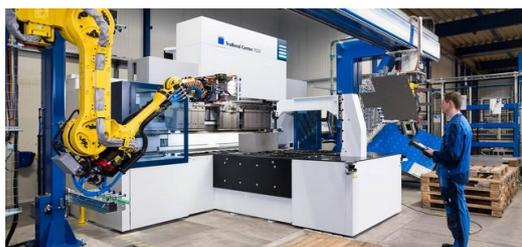
A rendere possibile la produzione del forno da campo è stata la nuova piegatrice a grembiale TruBend Center 7020. Solo grazie a quest'impianto il team di Kuipers è riuscito a piegare in modo automatizzato la camera di combustione relativamente grande di 333 millimetri.
