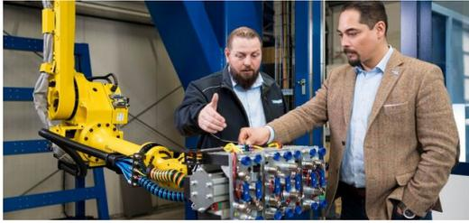
Giusto in tempo è stata messa in funzione anche l'automazione del robot per le operazioni di carico e scarico della TruBend Center 7020. "Questo velocizza ulteriormente il processo di produzione" afferma Michael Kuipers (a destra), mentre Karsten Hanenkamp aggiunge: "I gripper dispongono i pezzi finiti sulle palette a disposizione per trasportarli nella stazione di saldatura".
