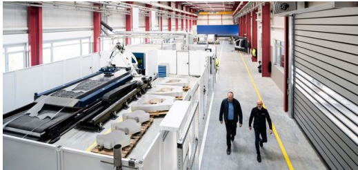
L'impianto di laser blanking di 34 metri di lunghezza di TRUMPF risparmia materiale grezzo e circa 4.000 tonnellate di CO 2 all'anno.
