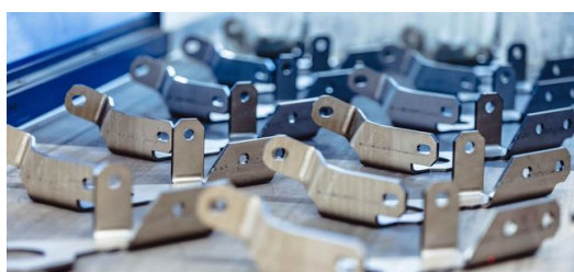
Per la fabbricazione di lamiere, MERZ lavora ogni giorno con esercizio a tre turni tra le dieci e le 15 tonnellate di lamiera sottile. L'elevata varietà di pezzi con quantità da uno a 1.000 e l'alta pressione sulle scadenze sono sfide all'ordine del giorno.
