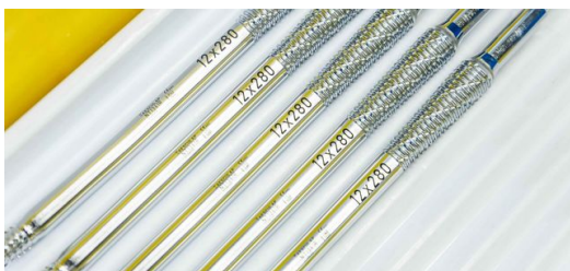
A TRUMPF TruMicro Mark ultrarövid impulzusú lézereivel a vállalat robusztus és tartós jelöléseket visz fel.
