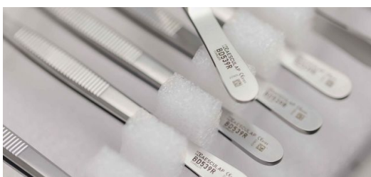
A Suzhou-i csapat több, mint egy millió sebészeti eszközt - részben kicsi sorozatokban - lát el évente pontos jelölésekkel.
