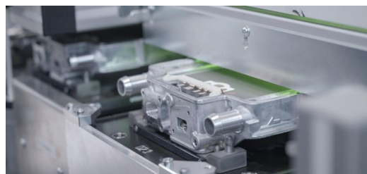
Lézer 2: Réz kontaktolása zöld lézerekkel. A TRUMPF lézerek zöld hullámhosszáknak nagyobb az abszorpciós foka rézben. A megfelelő
