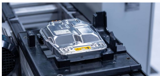
Lézer 1: Alumínium gáztömör hegesztése. A Webasto egy diszklézert használ, amely atmoszférikus nyomáson védőgáz nélkül is dolgozik - a
