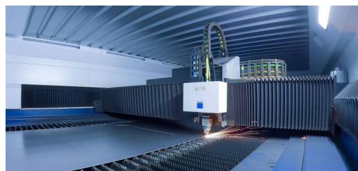
La tête laser file à toute allure au-dessus de la bande de tôle presque infinie et découpe les contours des pièces de l'enveloppe extérieure des tracteurs Fendt.
