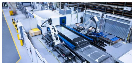
Vue d'ensemble de la TruLaser 8000 Coil Edition : sur cette image, on remarque à quel point les chutes de tôle sont moins nombreuses lorsque Fendt découpe à partir d'une bobine et non à partir de la feuille de tôle.
