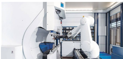
Cellule de pliage à grande vitesse innovante : le système compact de la TruBend Cell 7000 permet de plier de petites pièces de manière ultra-rapide
