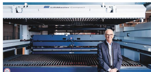
En combinaison avec le LiftMaster Compact et le Part Master, le système découpe les pièces de manière entièrement automatique dans la
