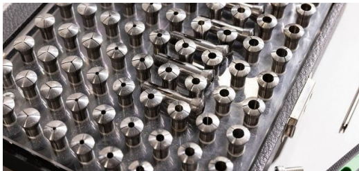
Grâce à des outils très flexibles, le réglage du support de pièce et l'alignement des systèmes optiques dure moins de cinq minutes : voici les outils pour le support de pièces.
