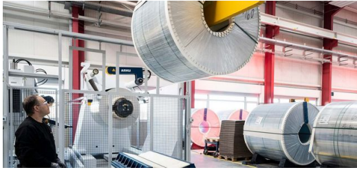
L'opérateur machine Martin Müller hisse une bobine de feuillard d'aluminium de 16 tonnes dans la zone de chargement de la TruLaser 8000 Coil Edition de TRUMPF.
