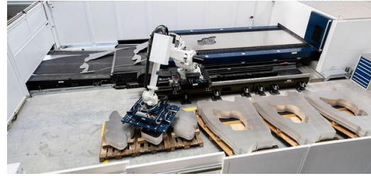
Laser Blanking : un robot trie automatiquement les composés découpés.
