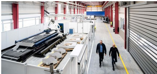
L'installation de Laser Blanking de TRUMPF de 34 mètres de long permet d'économiser de la matière brute et environ 4000 tonnes de CO 2 par an.
